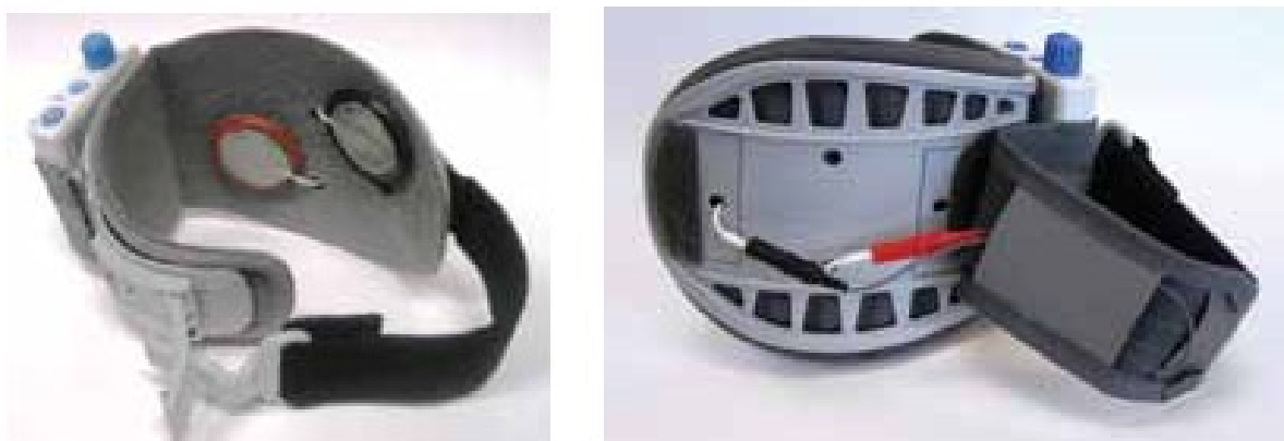
Рис 9 и 10: Замена электродов (вид изнутри и снаружи)
